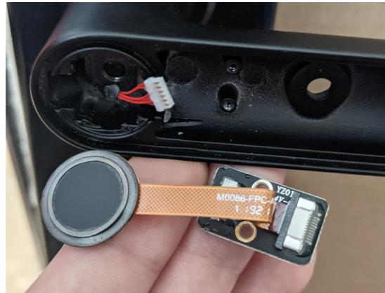
(d) Removing the fingerprint module
